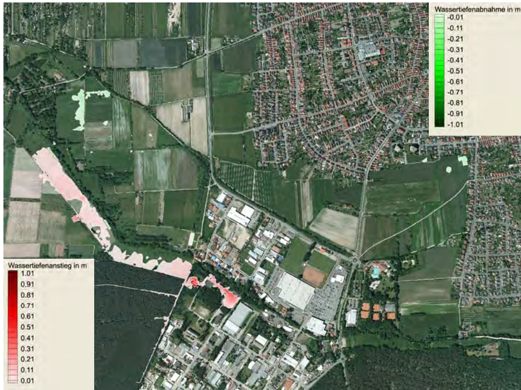
Abbildung 68: Auswirkungen standhaltender rechtsseitiger Rehbachverwallungen auf die 100-jährlichen Wassertiefen in der Ortslage von Haßloch und im Industriegebiet Süd bei Stärkung der Retention in allen vier Teilräumen (Unterschied Variante R1234-2 zu Variante R1234-1)
