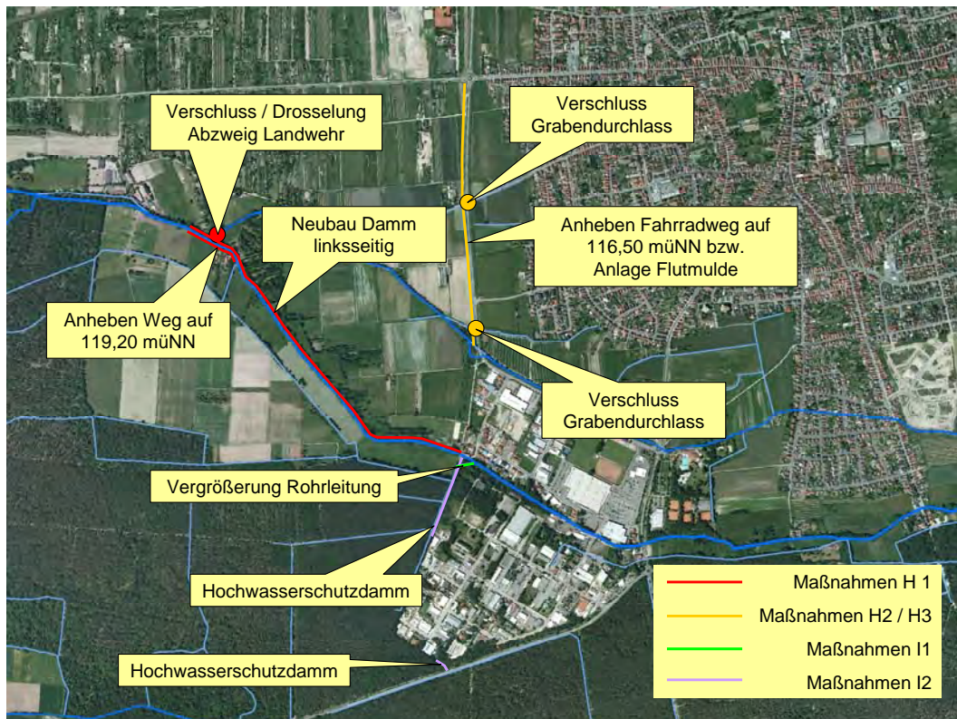
Abbildung 70: Übersicht der örtlichen Maßnahmen zum Schutz von Haßloch-West und des Industriegebiets Süd
