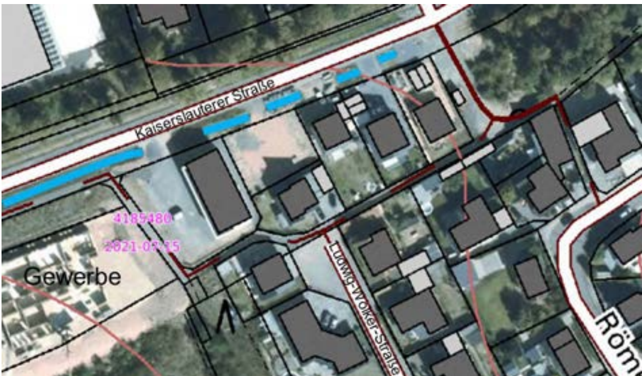
Abb. 22: Versickerungs- und Abflussmulde neben der Kaiserslauterer Straße
