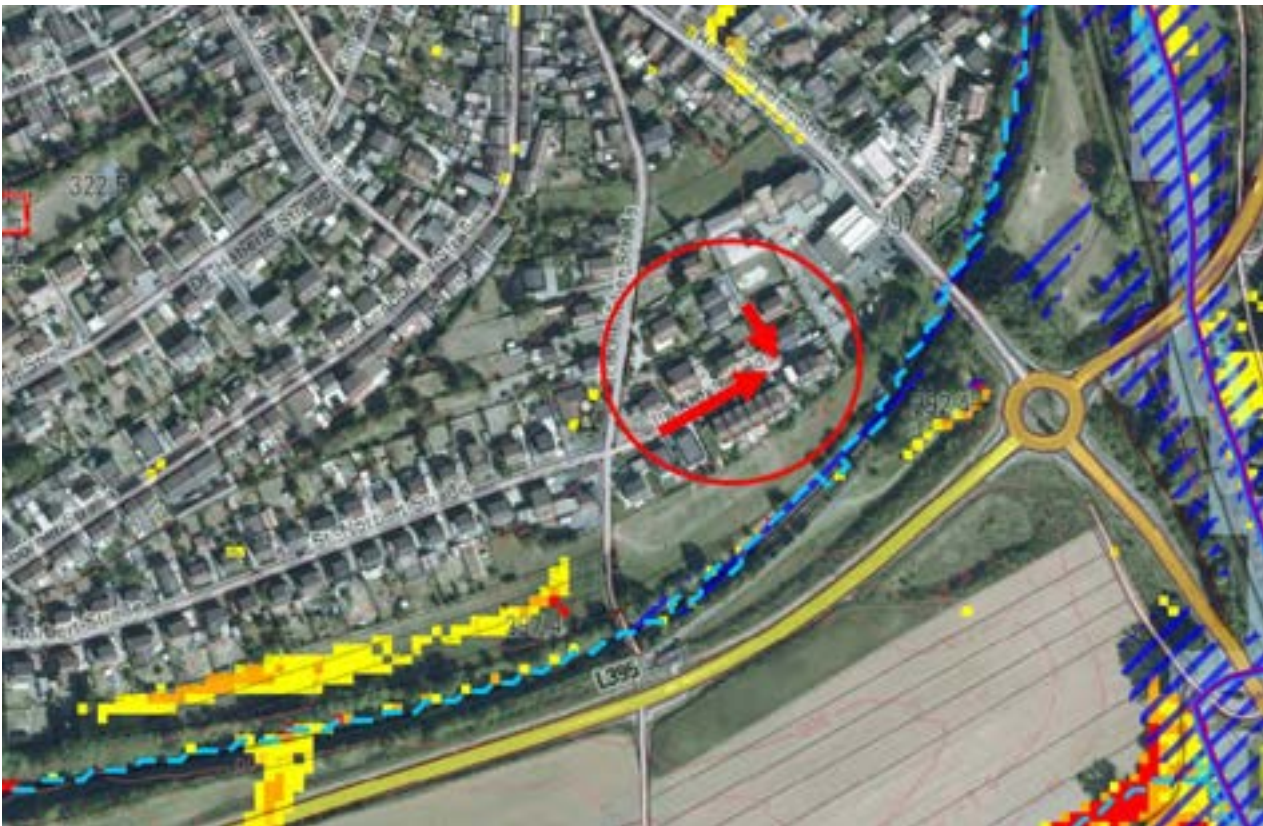
Abb. 30: Abflusssituation bei Starkregen im Klosterfeld
