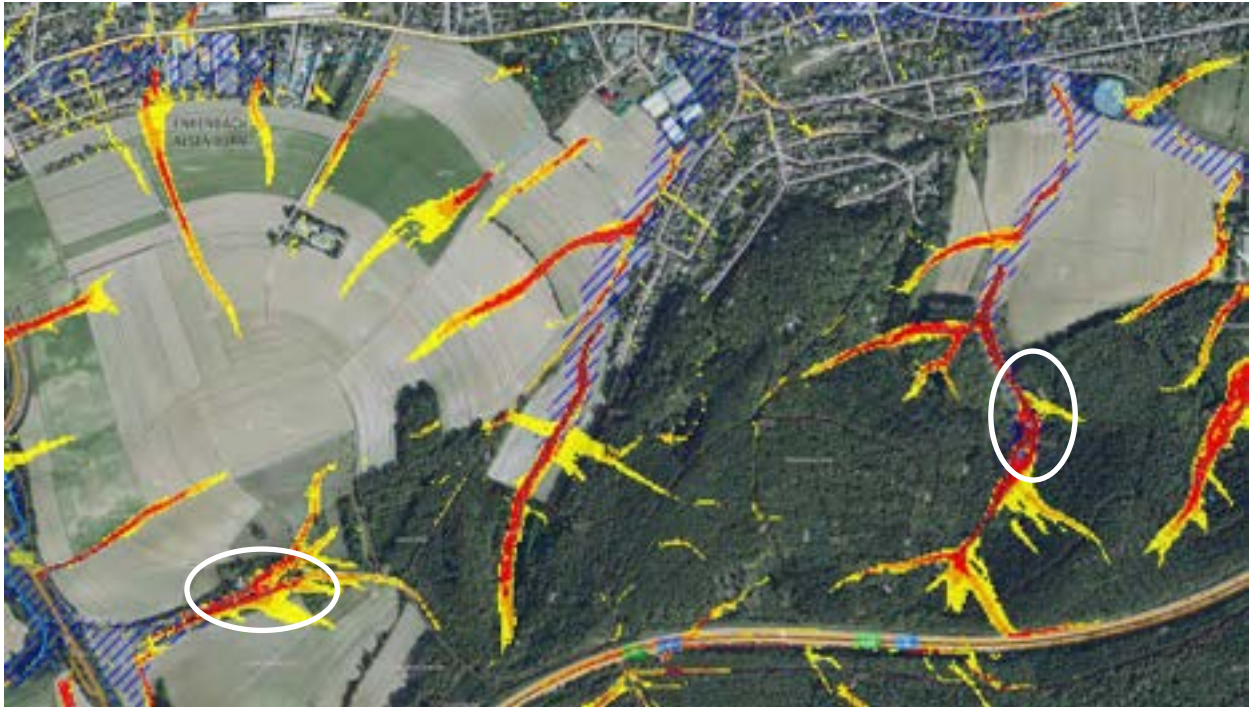
Abb. 5: Lage der Hochbehälter Enkenbach (links) und Alsenborn (rechts) jeweils im überflutungsgefährdeten Bereich
