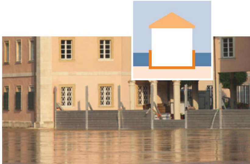
Abbildung 14: Strategie Widerstehen, hier durch Objektschutz [Hochwasserschutzfibel]
