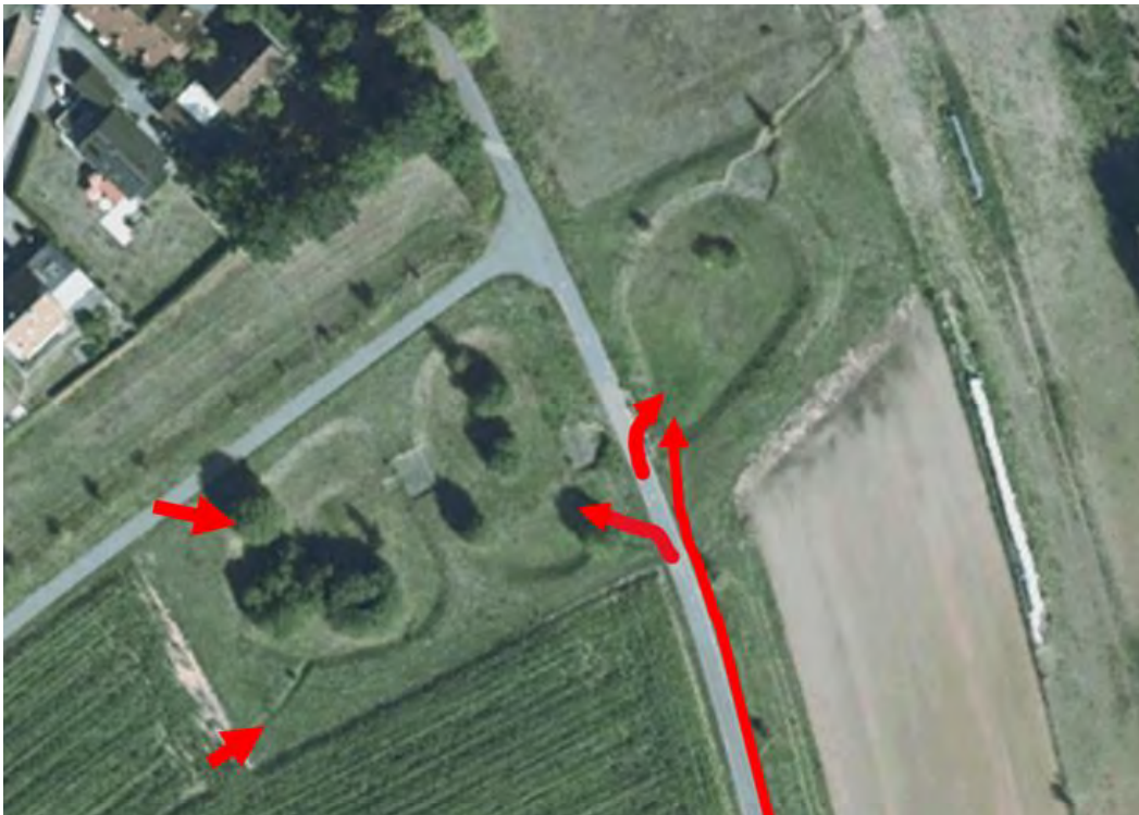
Abb. 35: Zuläufe in die 3-stufige Beckenkaskade
