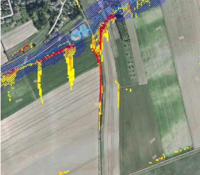
Abb. 36: Potenzielle Zuflusswege in die RRB-Kaskade
