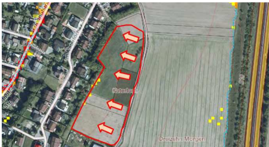
Abb. 66: Breitflächiger Oberflächenabfluss zum Lärmschutzwall Katerloch
