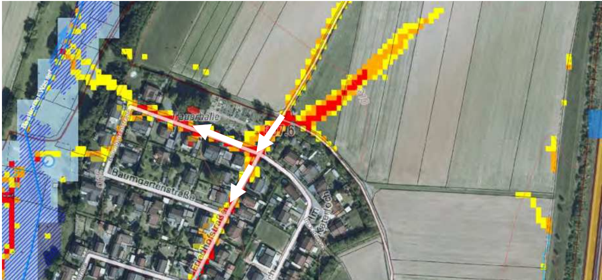
Abb. 74: Abflusswege am Friedhof in die Ortslage
