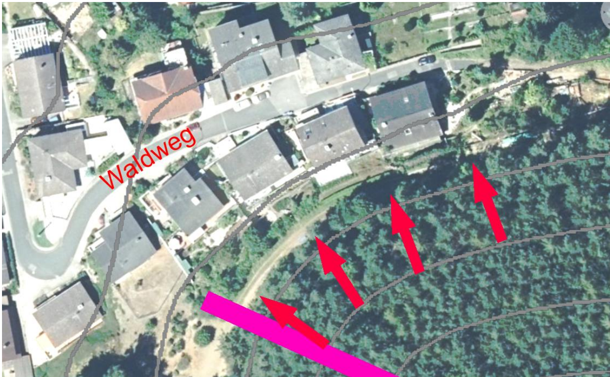
Abbildung 165: Zufluss zu Gebäuderückseiten im "Waldweg"
