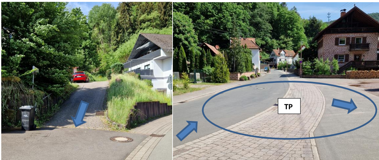
Abbildung 82: einfallende Talkerbe (links), Tiefpunktbereich des Notabflusswegs (rechts)
