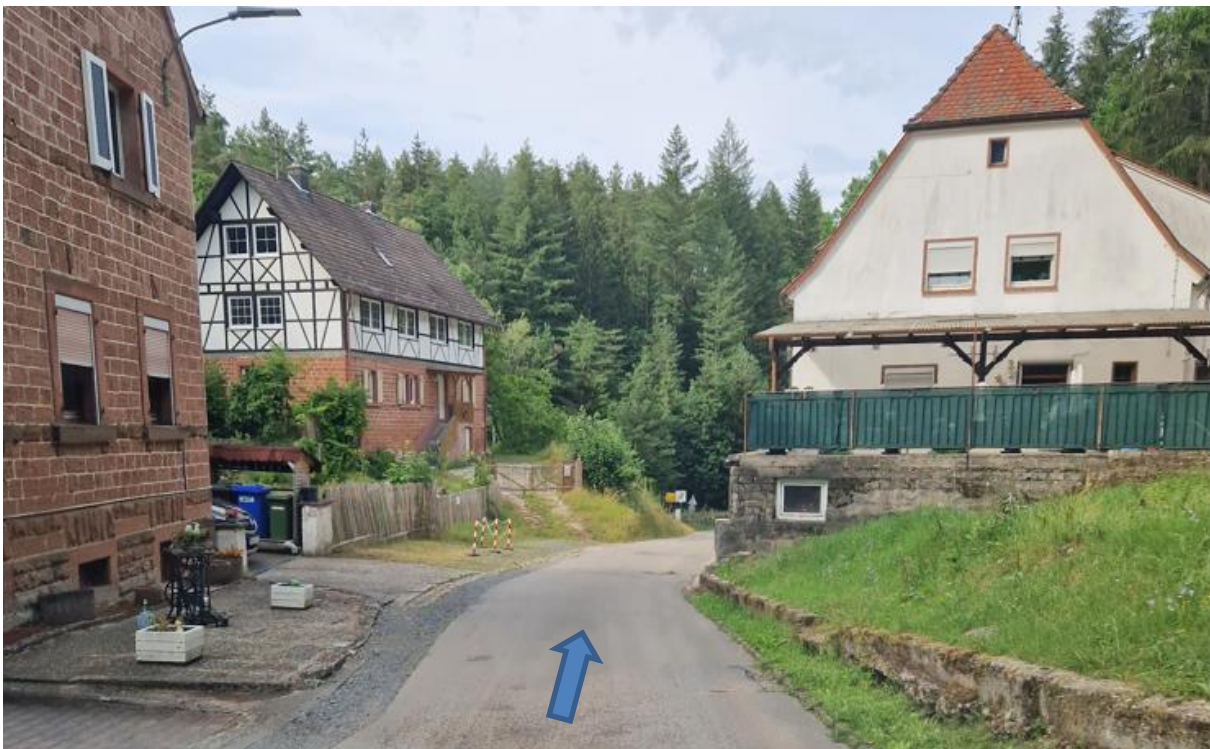
Abbildung 119: Ortsstraße Röderthal als Notabflussweg
