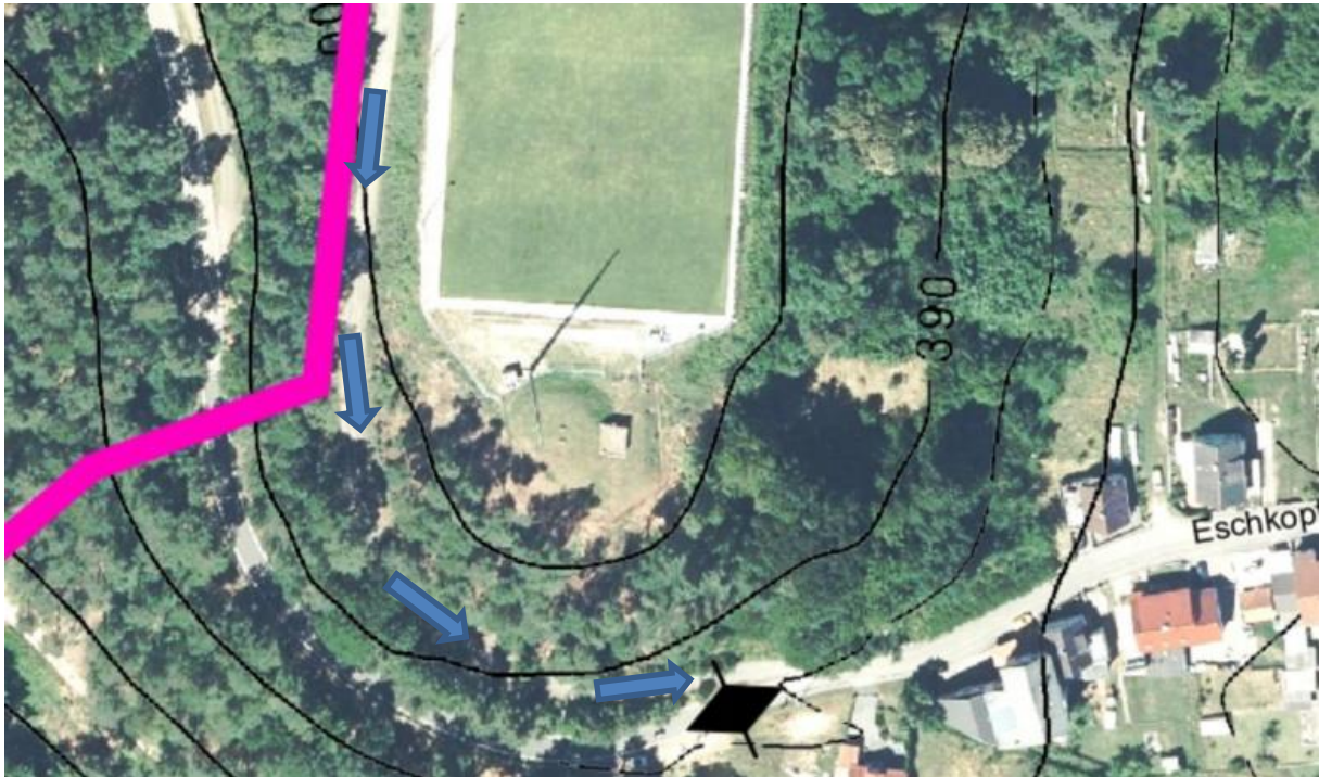
Abbildung 127: Abflussweg Weg zum Sportplatz
