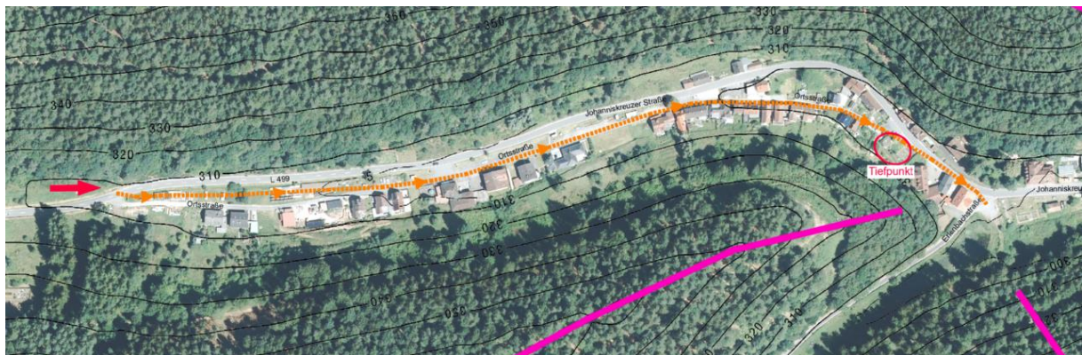
Abbildung 107: Darstellung des Notabflusswegs Speyerbrunn
