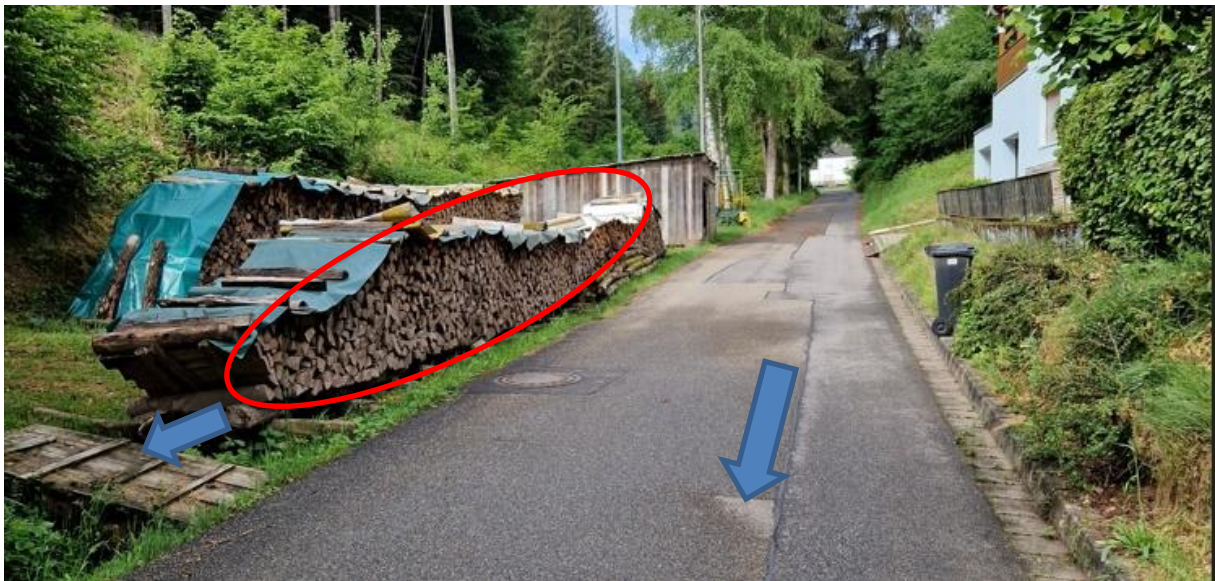
Abbildung 104: Holzlager direkt am Notabflussweg, bzw. direkt über dem Gewässer
