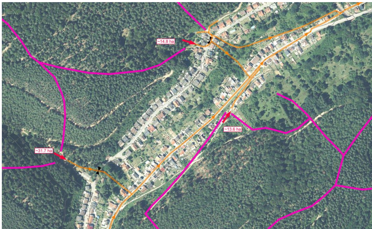
Abbildung 301: Darstellung des Notabflusswegs Langentalstraße, mittlerer Bereich
