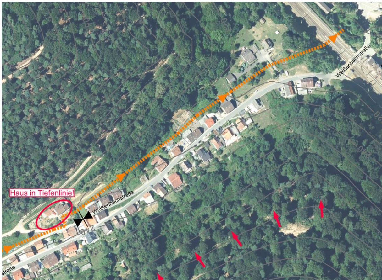
Abbildung 315: Darstellung des Notabflusswegs Weißenbachstraße (unterer Bereich)
