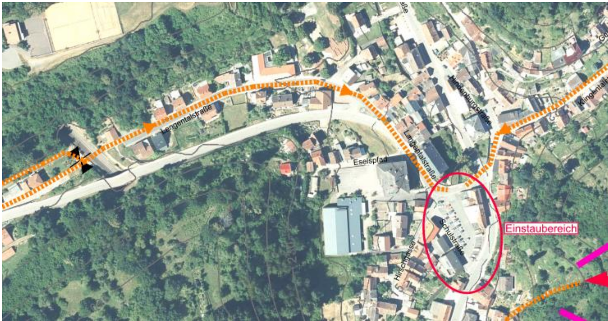
Abbildung 303: Darstellung des Notabflusswegs Langentalstraße, unterer Bereich
