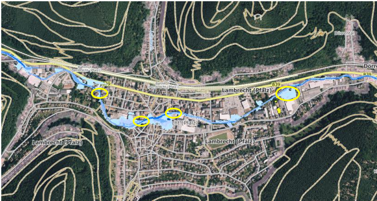
Abbildung 224: Darstellung der Überschwemmungsflächen bei einem HQ 100 , mit Darstellung der hydraulischen Engstellen
